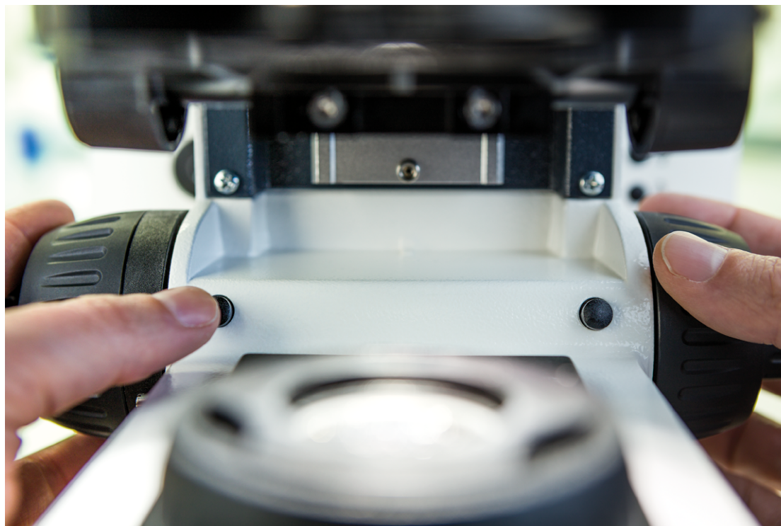
Axioscópico 5: Botão Snap para aquisição de imagem em ambos os lados
